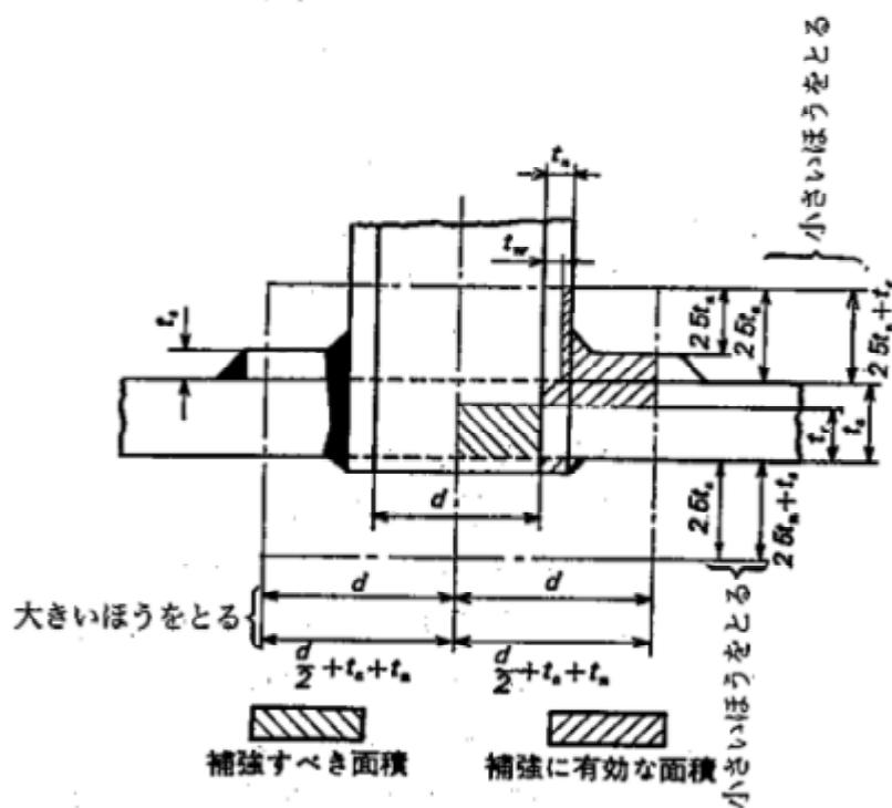
(a) 穴の中心線に平行な直線を引く位置は、穴の中心線からその両側に次の長さのうちいずれか大きいものの距離にある位置とする。
