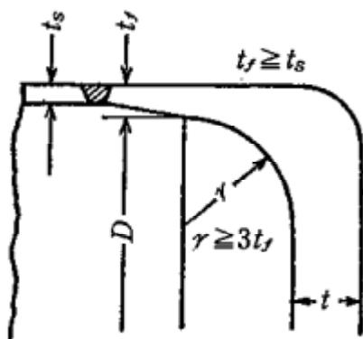
法兰ジ付きの平板が胴と一体成形され、又は胴に突合せ溶接される場合
