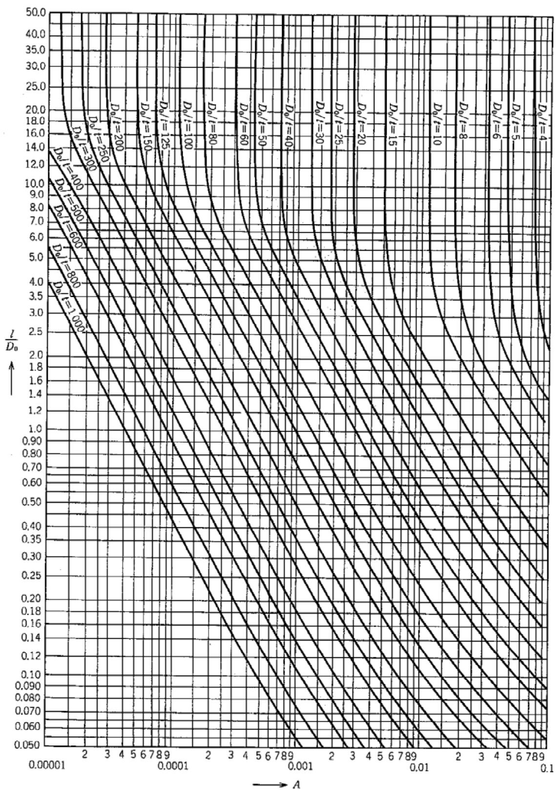
別図B 外圧を受ける円筒胴又は球形胴の計算に用いる材料曲線
