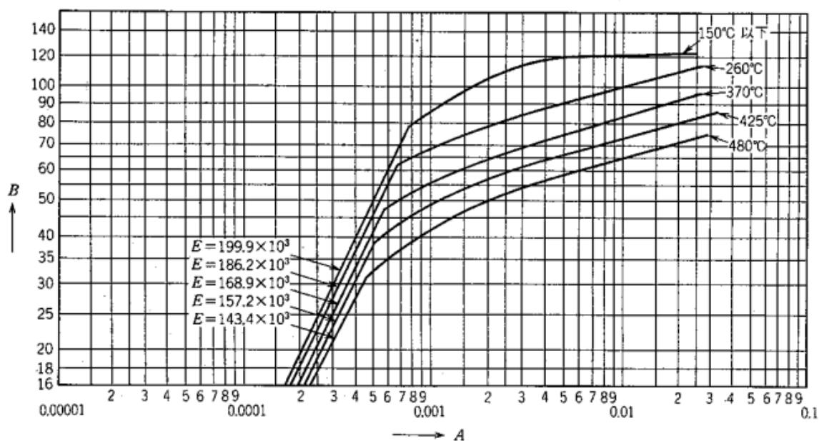
別図 B - 3 炭素鋼及び低合金鋼（規格最小降伏点262 N/mm<sup>2</sup>以上）
