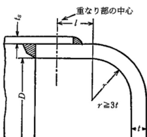
法兰ジ付き平板が胴と両側全厚すみ肉重ね溶接 (ろう付けを含む。) される場合
