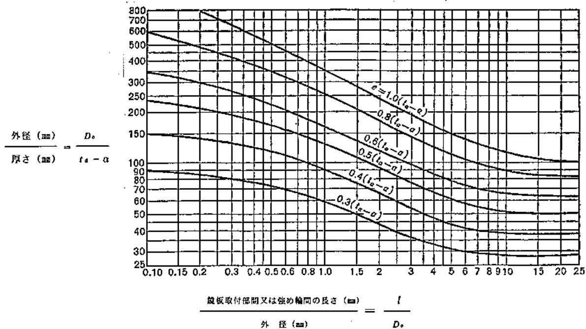
図 26-6 弧の長さを求める図表
