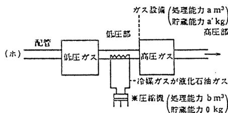
備考 いわゆる付属冷凍の圧縮機から第一種保安物件等に対する距離の算定は、当該付属冷凍の貯蔵能力 ( $0 \text{ kg}$ ) に対応する距離をとること。
