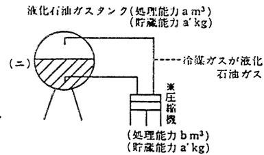
備考 いわゆる付属冷凍の圧縮機から第一種保安物件等に対する距離の算定は、当該付属冷凍の貯蔵能力 ( $a' \text{ kg}$ ) に対応する距離をとること。
