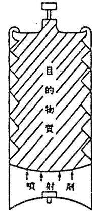
なお、当該エアゾールの容器の内容積の算定は、目的物質及び噴射剤が混合されている一般のエアゾールの場合と同様に目的物質及び噴射剤の体積を合算したものとす。
