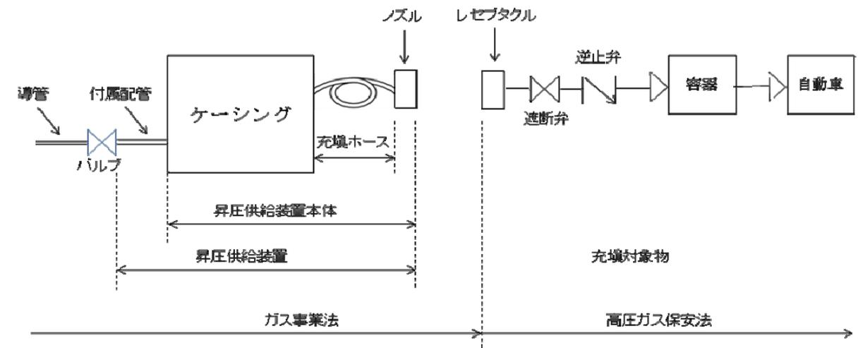
第1項第25号及び26号中「圧縮水素を燃料として使用する車両に固定した燃料装置用容器」について
