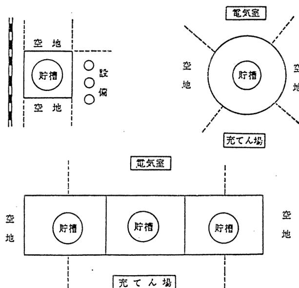
2. 防液堤に関する一般高圧ガス保安規則関係例示基準5及び液化石油ガス保安規則例示関係基準10中集合防液堤に複数の貯槽を設置する場合の防液堤の容量についての特例を定めているが、この場合において、これらの基準2の項（容量）の表備考により間仕切り防液堤が必要であり、
