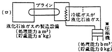
備考 いわゆる付属冷凍の圧縮機から第一種保安物件等に対する距離の算定は、当該付属冷凍の貯蔵能力 ( $0 \text{ kg}$ ) に対応する距離をとること。
