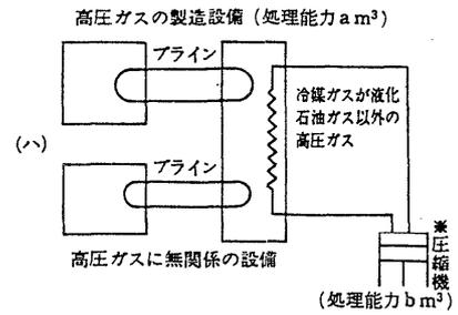
備考 いわゆる付属冷凍の圧縮機から第一種保安物件等に対する距離の算定は、当該付属冷凍の処理能力 ( $b \text{ m}^3$ ) に対応する距離をとること。
