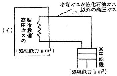
備考 いわゆる付属冷凍の圧縮機から第一種保安物件等に対する距離の算定は、当該付属冷凍の処理能力 ( $b \text{ m}^3$ ) に対応する距離をとること。
