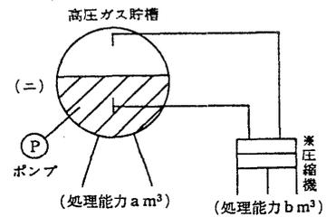
備考 いわゆる付属冷凍の圧縮機から第一種保安物件等に対する距離の算定は、当該付属冷凍の製造設備の処理能力 ( $a + b \text{ m}^3$ ) に対応する距離をとること。
