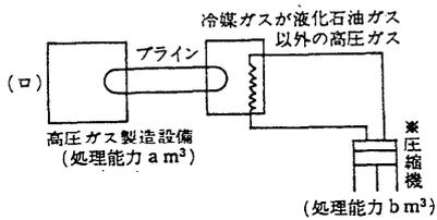
備考 いわゆる付属冷凍の圧縮機から第一種保安物件等に対する距離の算定は、当該付属冷凍の処理能力 ( $b \text{ m}^3$ ) に対応する距離をとること。
