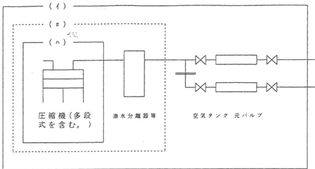
「温度35度においてゲージ圧力5メガパスカル」とは、空気タンクを有する圧縮装置（上図の（イ）のケース）については、空気タンク内の圧力を温度35度における圧力に換算した圧力とし、空気タンクを有しない圧縮装置（上図（ロ）又は（ハ）のケース）については、圧縮機の吐出し圧力を温度35度における圧力に換算した圧力とする。
