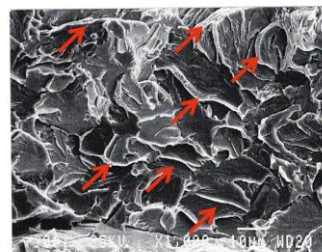
擬へき開 シャルピー衝撃試験 低合金鋼 室温
