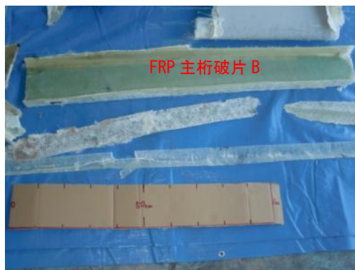
図 3-6 FRP 主桁破片 B
