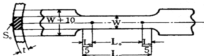
図 引張試験における試験片の寸法及び形状
