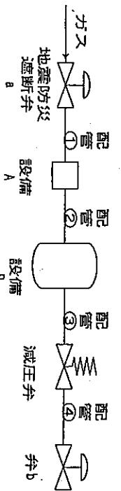
内容積 = 地震防災遮断弁 a の内容積の  $1/2$  + 配管①の内容積
