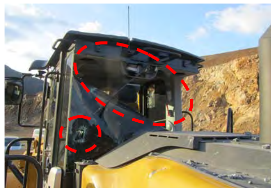
キャビン後部ガラス破損箇所
