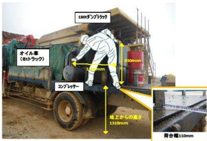
写真-1 コンプレッサー調整のためバルブに手を伸ばしたところ(推測)
