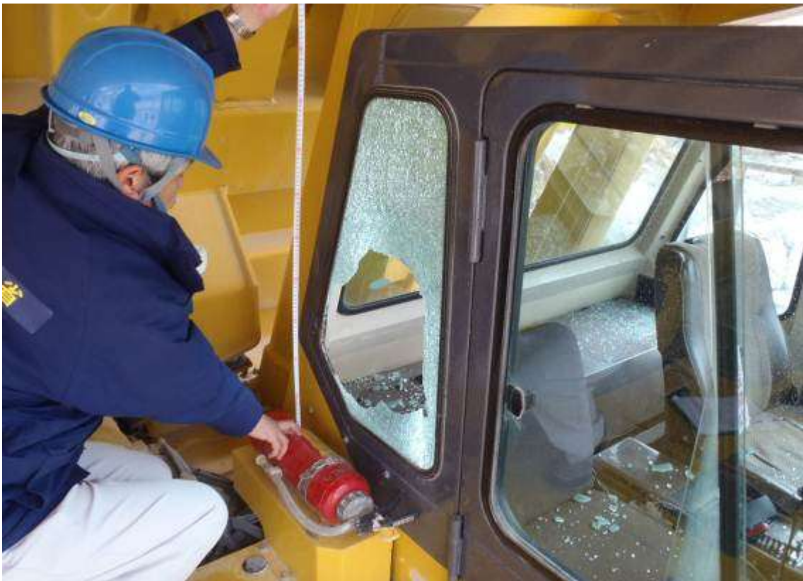
窓ガラスの破損状況
