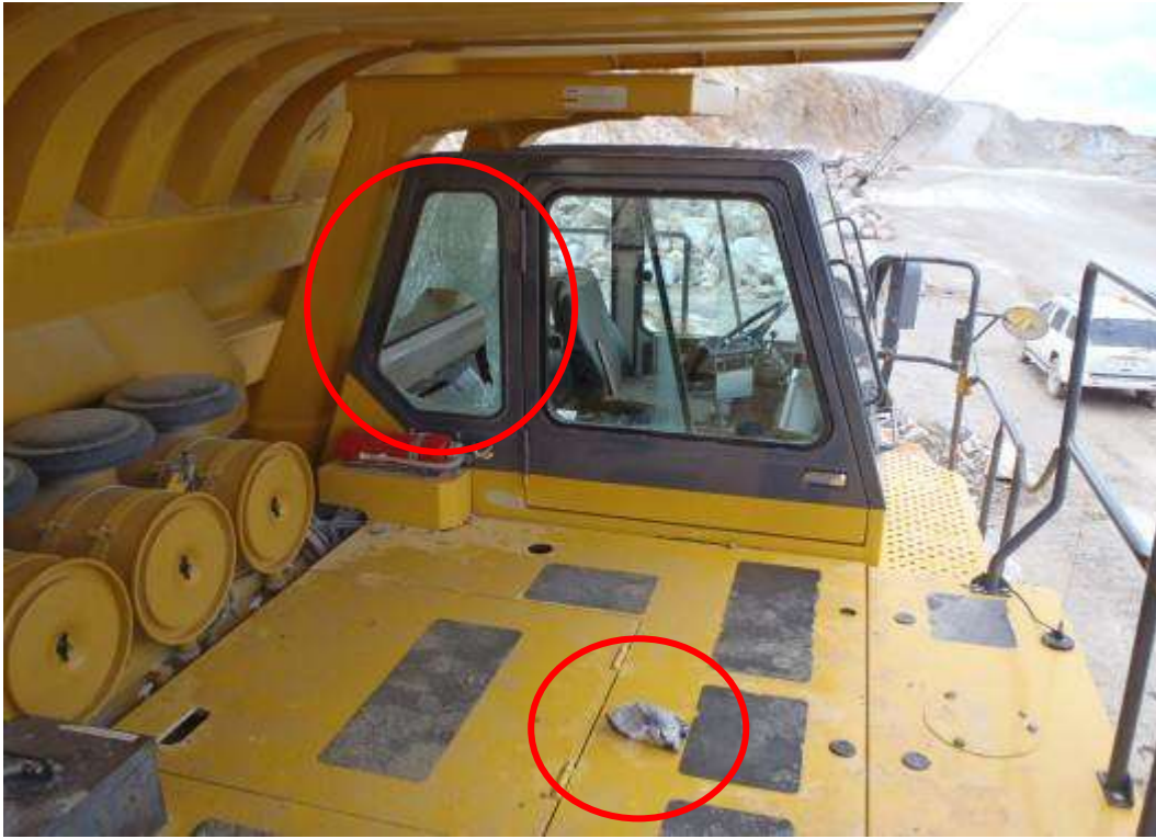
窓ガラスの破損状況と飛石の推定される石
