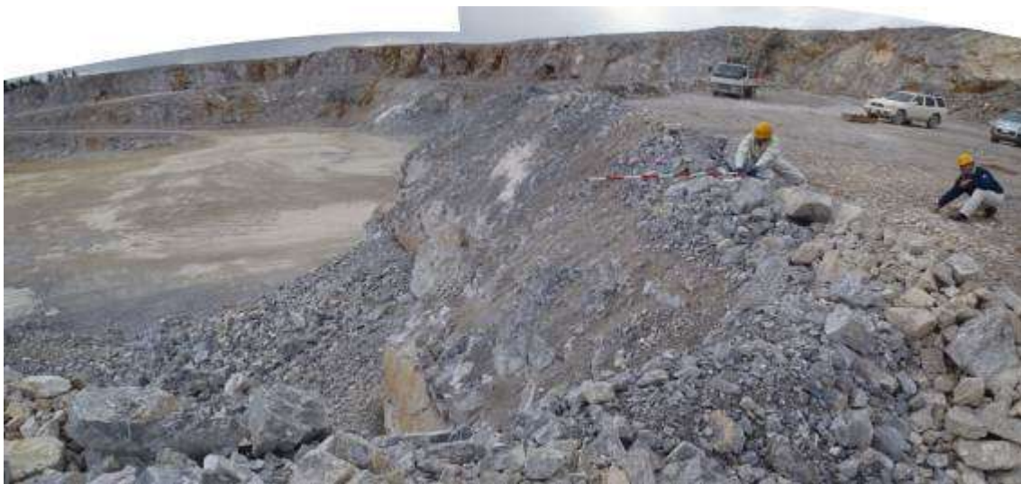
飛石が発生したと推定される535mL～520mL切羽の状況
