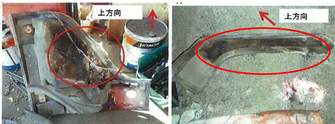
写真6 エンジンルーム内の操作用コントロールバルブと作動用ポンプの仕切用カバー内側 (当該カバー内側に吸音材が設置) の燃焼状況 (○が燃焼した箇所)
