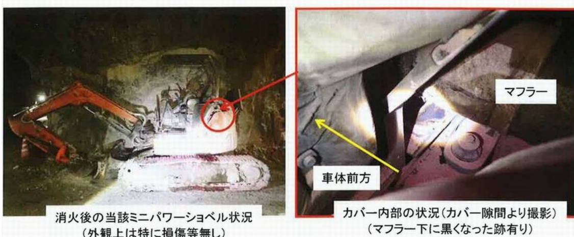
写真1 災害発生時の重機の状況
