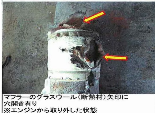
写真7 マフラーの断熱材の穴の状況
