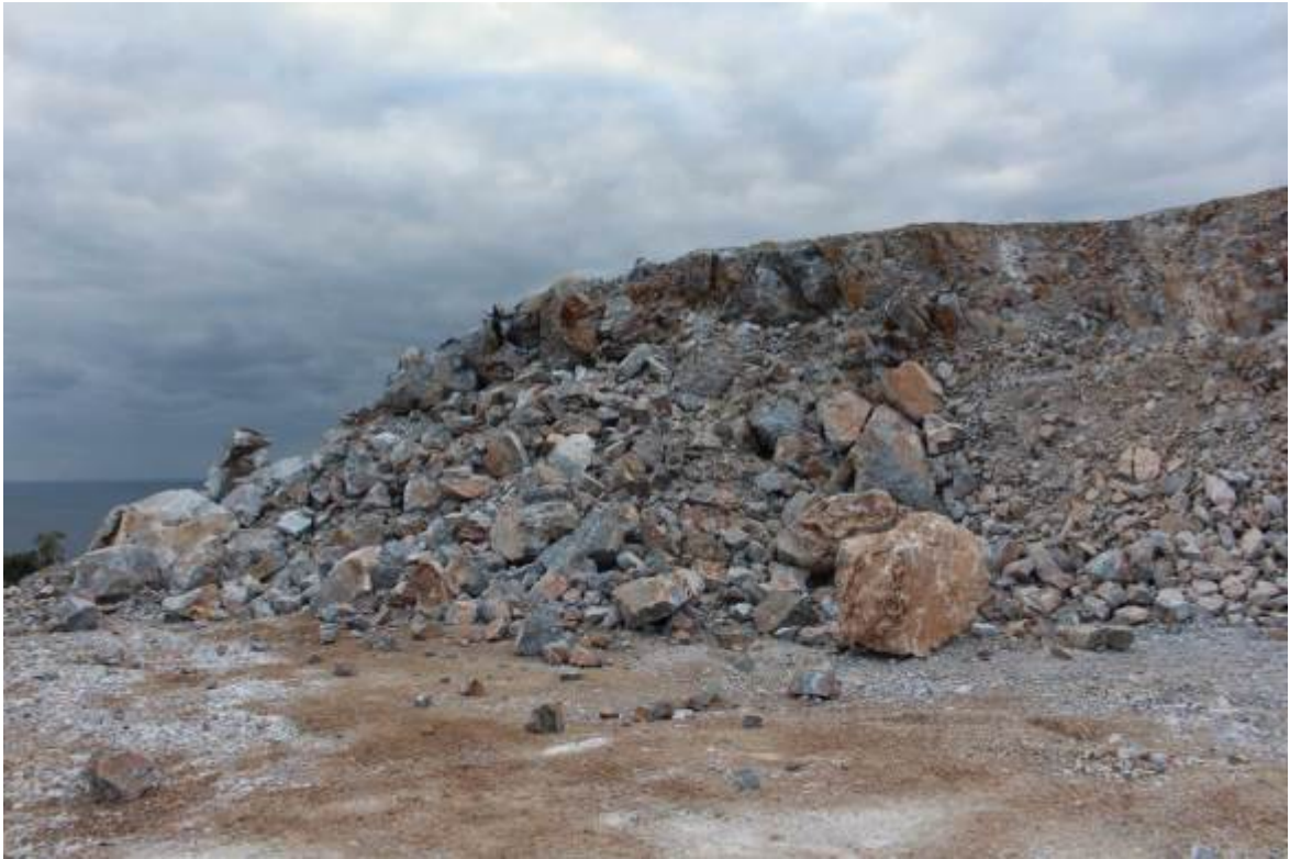
上部ベンチ 8.5 m L 発破箇所 崩壊箇所は左側端縁の下部
