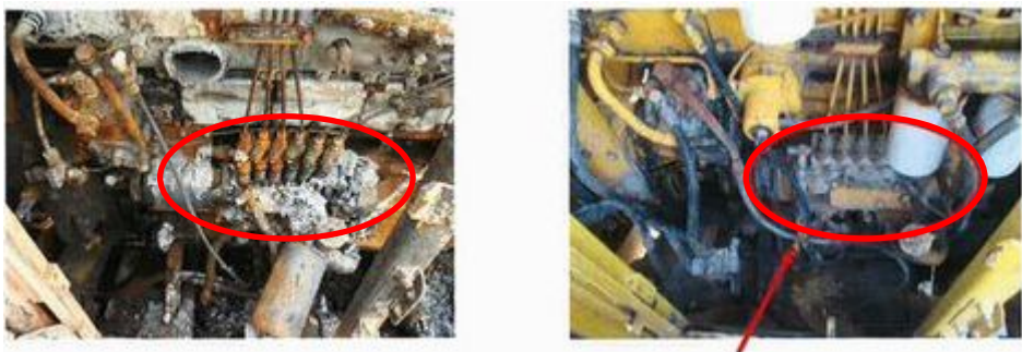
写真8 燃料噴射ポンプの状況
