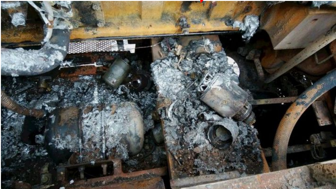
写真4 エンジン部の焼損状況
