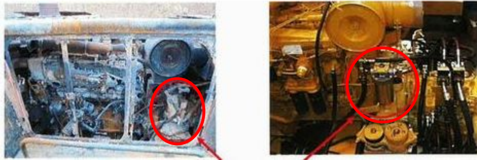
写真7 エンジンオイルフィルタ及び燃料フィルタの状況
