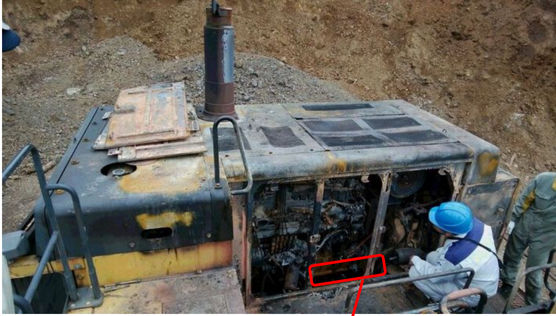
写真4 エンジン部の焼損状況
