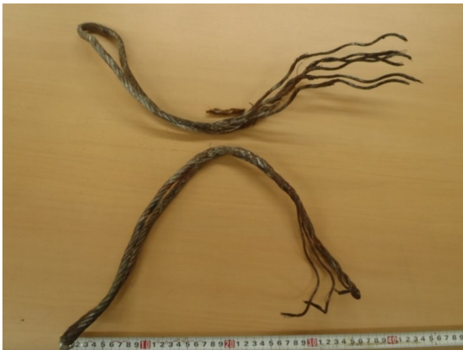
写真2 切れたワイヤーロープの状態
