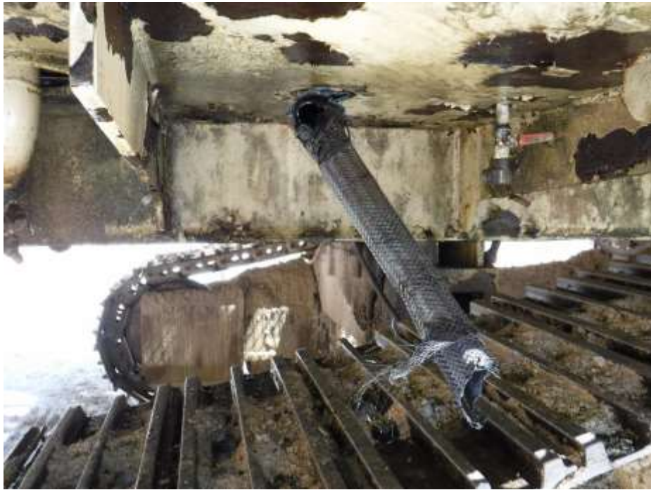
油圧ホースの破断状況（タンク下付近）
