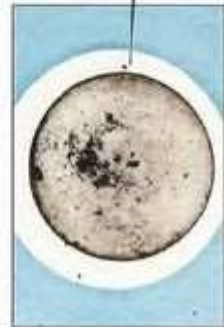
(2)-3 内外渡り線端子台 付着物 (ヘプタン洗浄後ろ過物)
