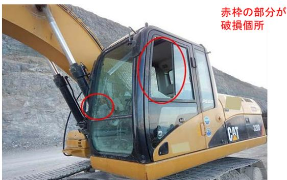
ベンチ発破を実施したところ、飛び石が発生し、隣接する鉱山の採掘場に駐車してあった油圧ショベルの窓ガラスが破損した。
