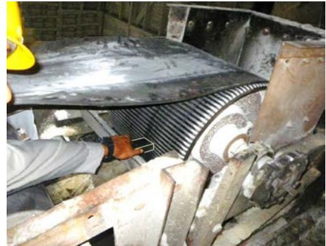
ベルトコンベアがスリップしたため、ヘッドプーリーに直接ベルトワックスを塗布しようとしたところ、腕を巻き込まれた。
