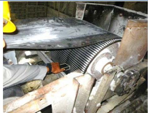
ベルトコンベアがスリップしたため、ヘッドプーリーに直接ベルトワックスを塗布しようとしたところ、腕を巻き込まれた。
