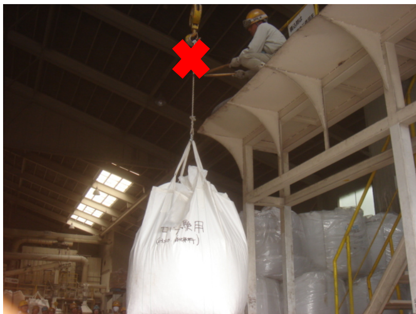
吊りロープを切断する
