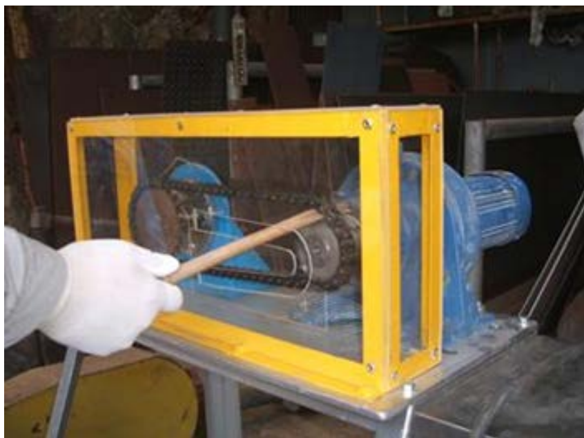
チェーンと sprocket の間に 竹棒を巻き込ませる
