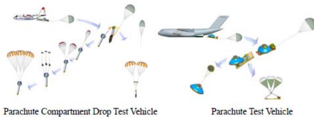
図 L-4-2-3 ARES 有人カプセルの回収実験
