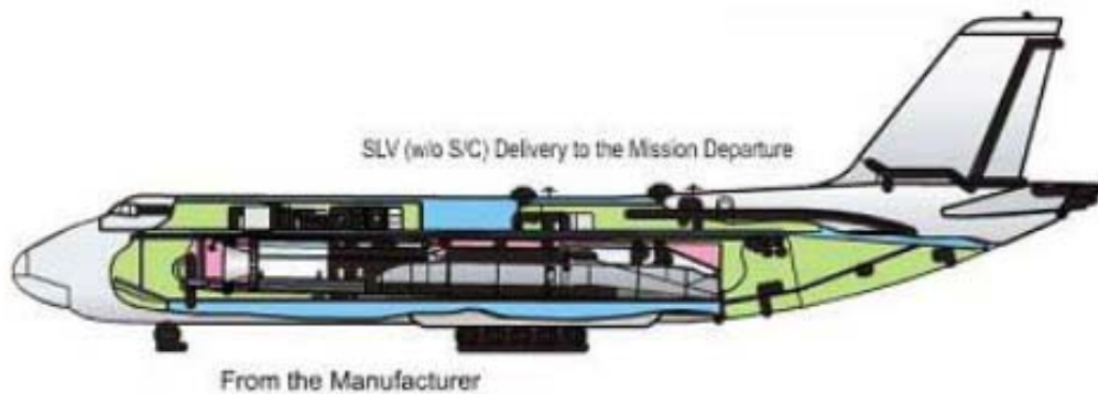
図 L-3-1-2-12 An124 内へのサイロ及びロケット搭載
