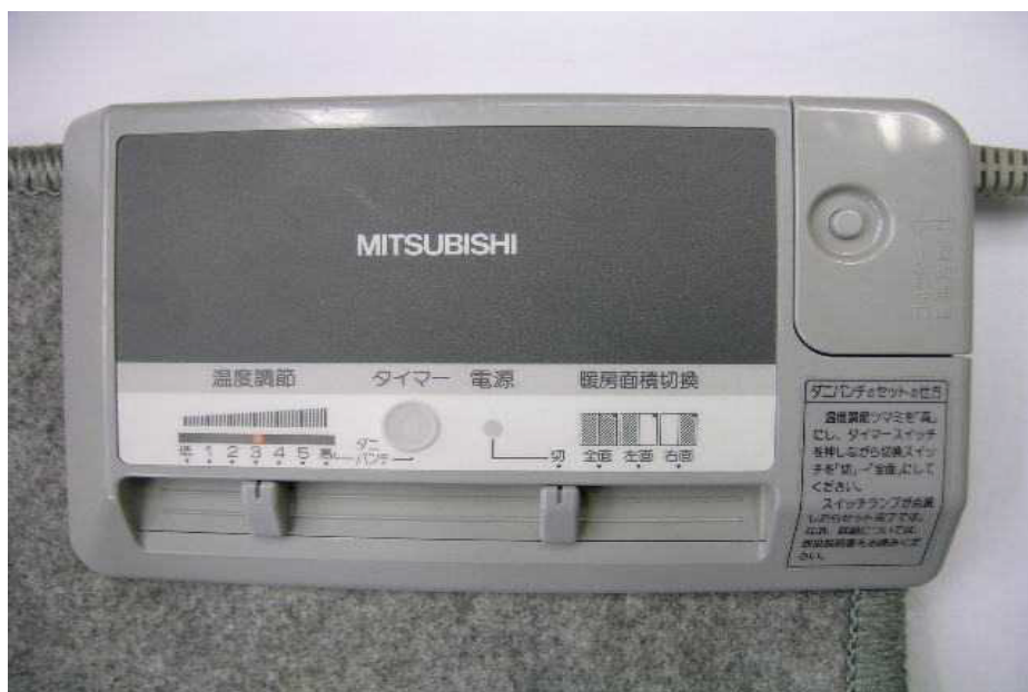
(電気カーペットコントローラー部)
