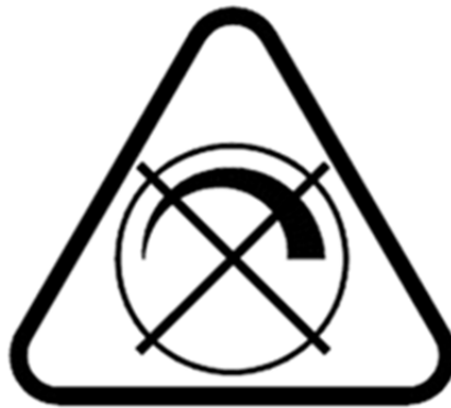
図2 - 調光機能が付いた照明器具での使用を認めないランプ
