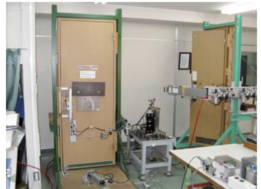
ドアの開閉繰り返し試験の様子
