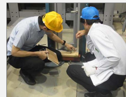
サッシの変形を確認
