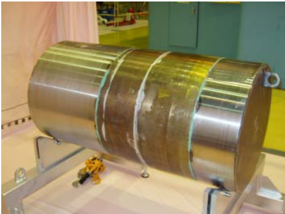
図 4.3-4 基準線(ケガキ)設置を完了した試験体1 (661-101-F12, 600A)
