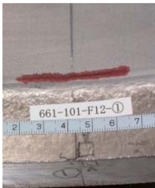
図 4.2-3 試験体の基準線（ケガキ線）と刻印の例 （精度確認試験）
