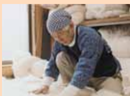
指先で綿の厚みの不揃いを調整している様子
