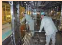
鉄道車両構体の歪取り作業(右側が受賞者)
