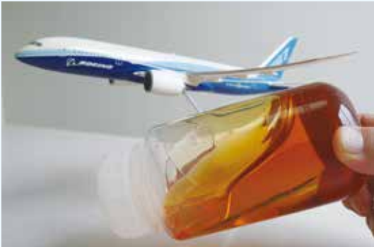
炭素繊維複合材料の強化に用いられるエポキシ樹脂
