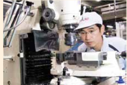
写真：フライス盤でポーリング加工をする塩崎氏
