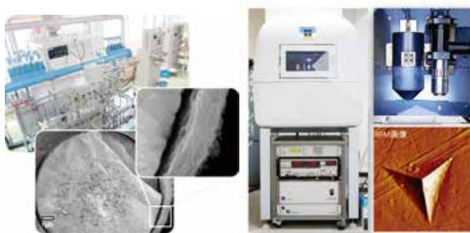
(a) CVI 連続炉及び同装置を用い炭素被覆されたセラミックス繊維 (b) 最新型高温ナノインデンターと同装置のSPM機能を用いた圧痕画像
