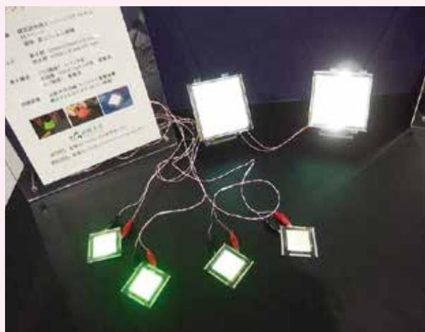
写真：(左) 超軽量 / 薄型フレキシブル有機太陽電池、(右) フレキシブル有機 EL 照明パネル (50mm 角、100mm 角)
