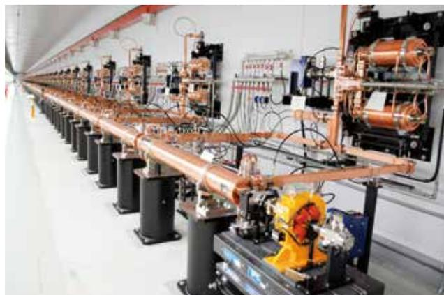
写真：電子を光速近くまで加速するCバンド加速管
