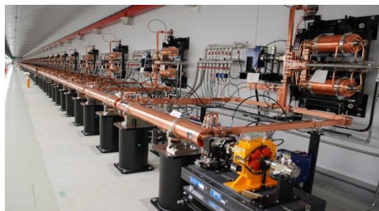
写真: 電子を光速近くまで加速するCバンド加速管
