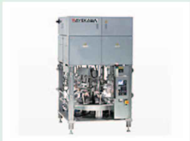
図 鶏もも肉全自動脱骨ロボット
