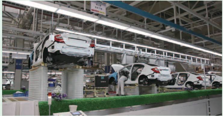
図 作業に応じて昇降可能な FALS で構築した組立ライン
