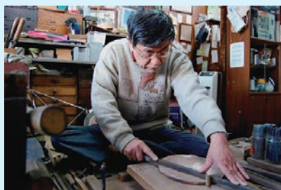
写真：鏡(やすり)切削・鏡の表面をやすりで研磨する工程。 全て手作業で一切の機械を用いない。
