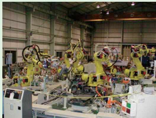
図2 車体組立用治具の仮設トライアル
