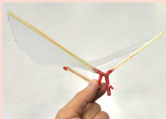
写真：3Dプリンタで部品を作ったはばたき飛行機
