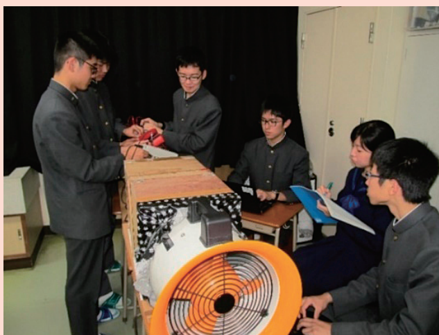
写真：自作の装置による風力発電効率の測定
