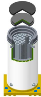
図2 乾式キャスクの構造
