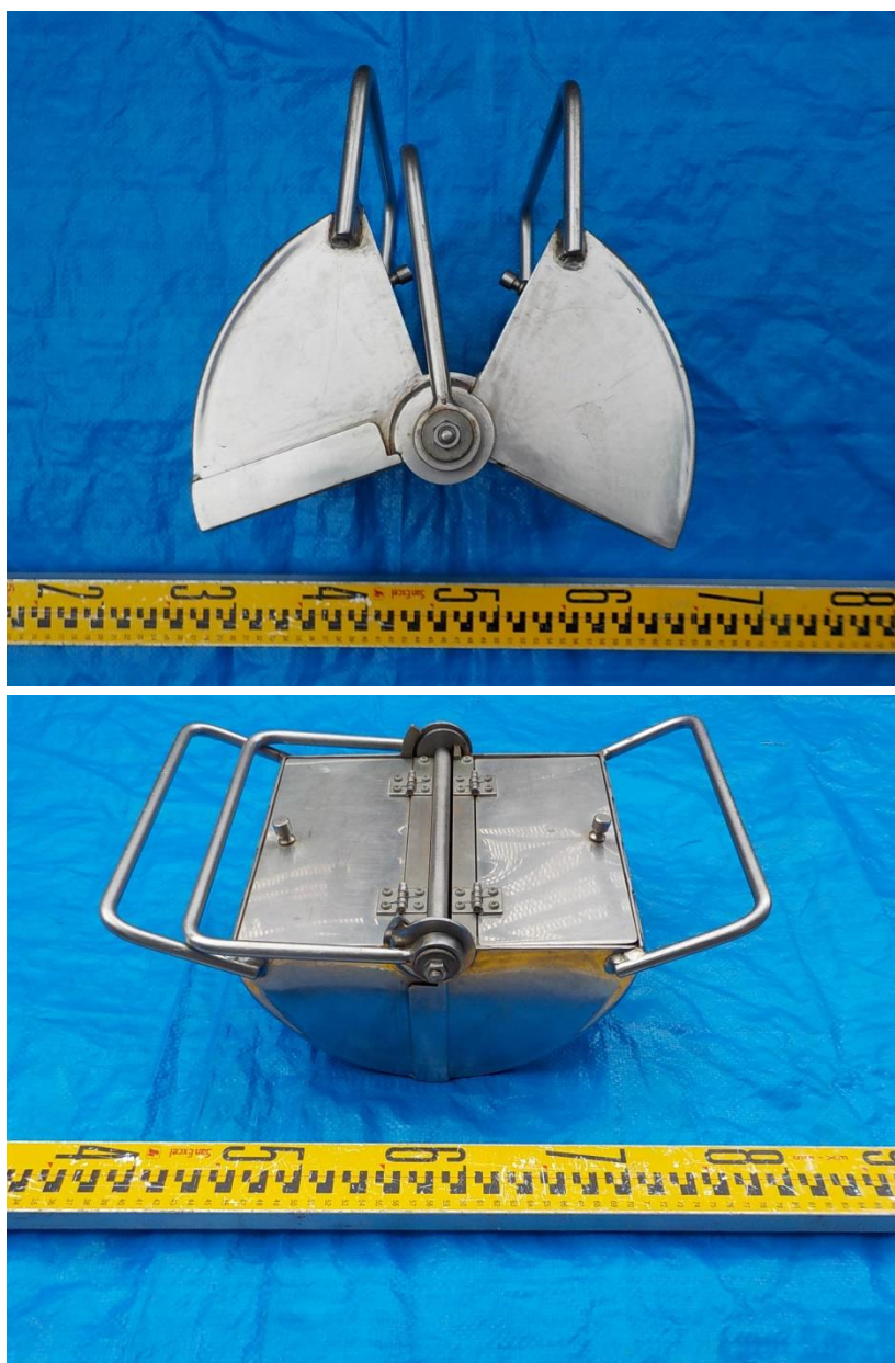
図 ハンドグラブサンプラー（採泥面積 22cm×22cm）
