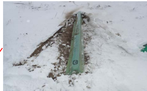
⑤ ブレード内部部材(長さ2m)
