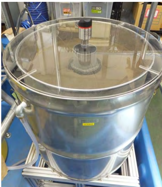
< 坑井模型（直径70cm、高さ50cm程度） >
