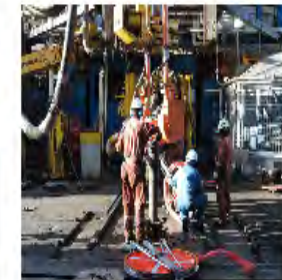
3) 電気検層準備作業中
