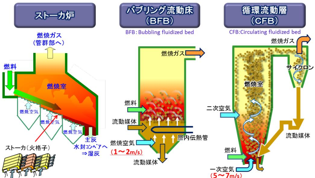
図 28：バイオマス発電技術の方式
