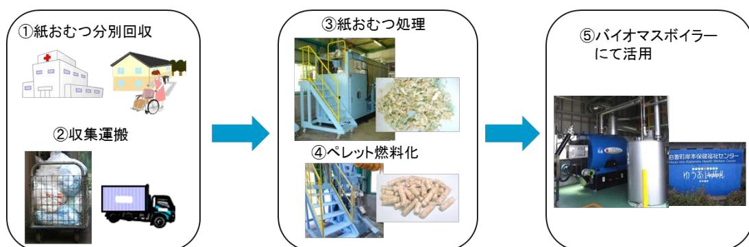
図 24：紙おむつ燃料化システムの導入例
