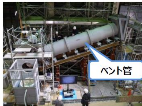
1 / 2スケール試験体で 止水性能を確認（工場）
