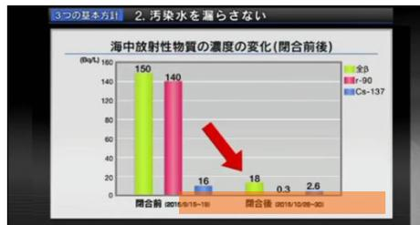
「漏らさない」対策としては、地下水とともに放射性物質が海洋へ流出することを防ぐため、「海側遮水壁」と呼ばれる鉄の壁が設置されています。
