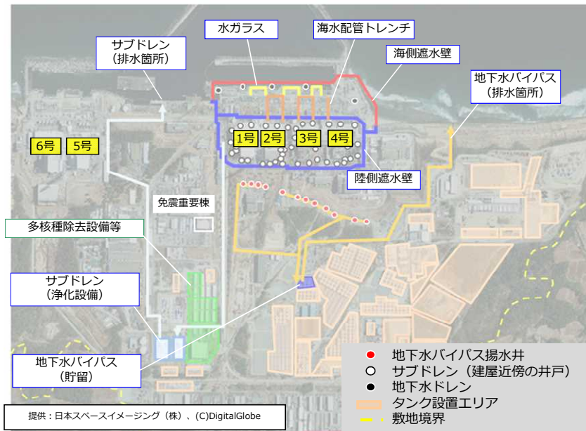
汚染水対策の概要図（敷地平面図）
