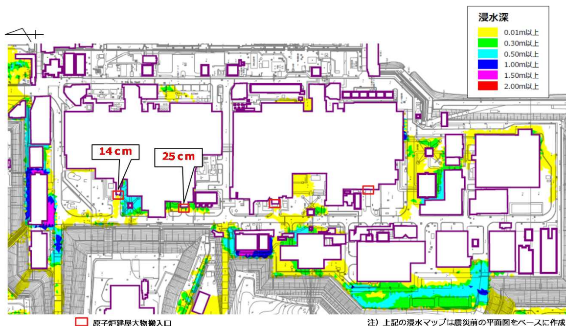
最大浸水深マップ（1～4号機建屋周辺）
