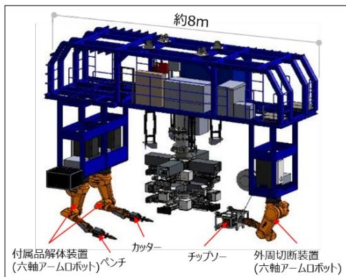
図6 排気筒筒身解体装置
