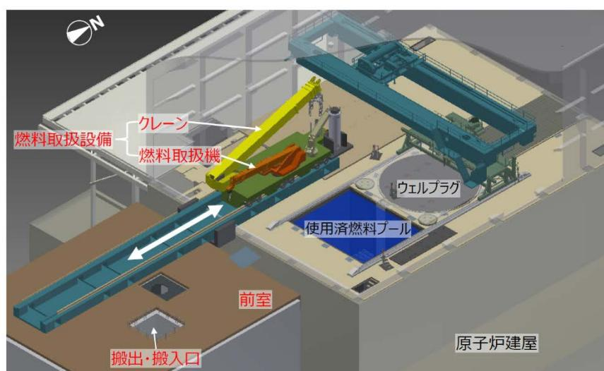
図 13 2号機の燃料取扱設備（イメージ図）
