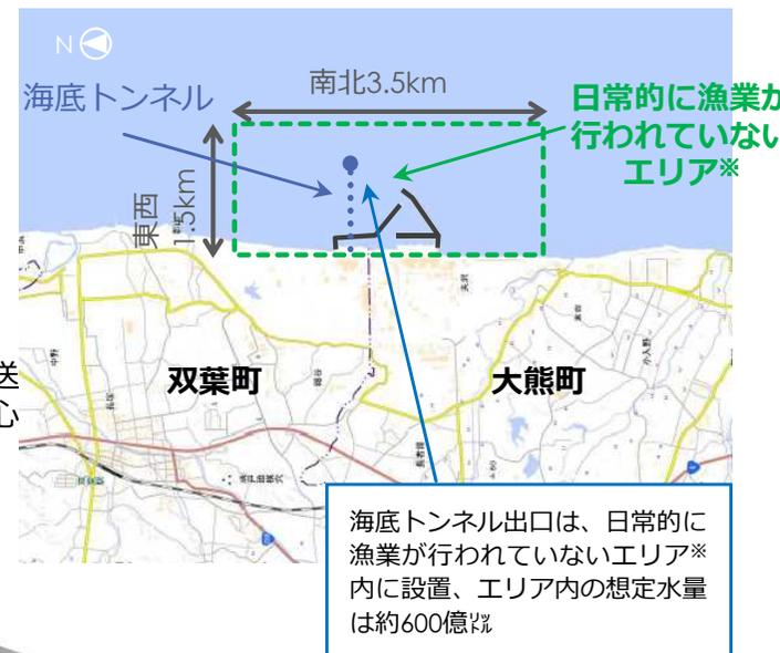
当面の間、立坑を活用して、海水とALPS処理水が混合・希釈していることを直接確認した後、放出を開始
