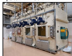
▲鉄セル 中線量サンプルの前処理に使用する。
