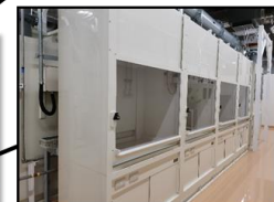
▲フード 低線量のサンプルの前処理に使用する。
