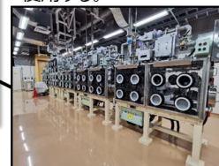
▲グローブボックス 低線量のサンプルの前処理 及び物性測定に使用する。
