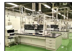
ICP-MS▶ 質量分析により 微量な長半減期核種の分析を行う。
