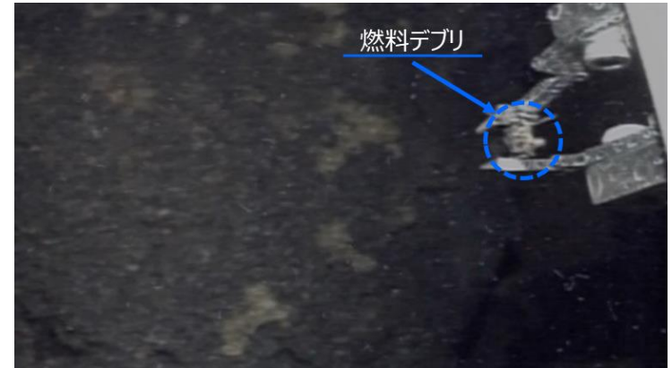
燃料デブリを先端治具で把持した状況
