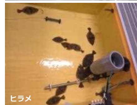
ALPS処理水添加水槽 (30ベクレル/ℓ程度)
