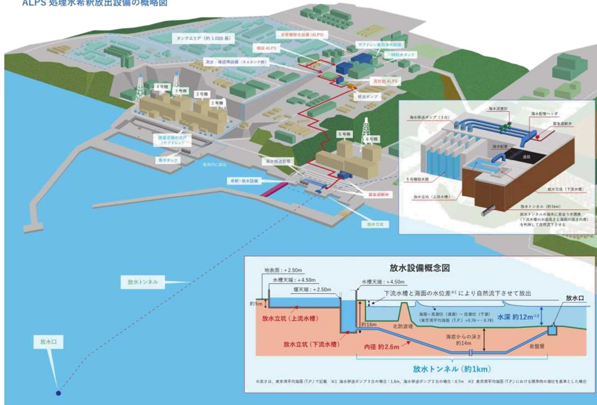
ALPS 処理水希釈放出設備の概略図
