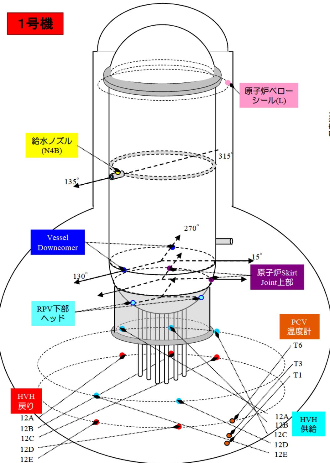
1号機 原子炉压力容器まわり温度(3/21~6/29)
