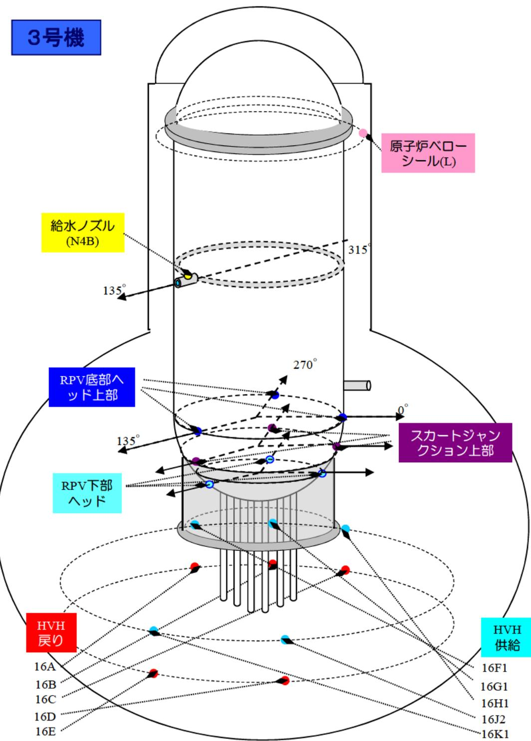
3号機 原子炉圧力容器まわり温度(3/21~6/29)
